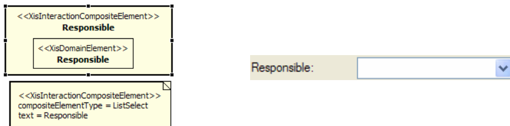
Figura 4.20: Representação de um XisInteractionCompositeElement cuja marca compositeElementType é ListSelect e respectiva geração para a plataforma Windows Forms.NET.
